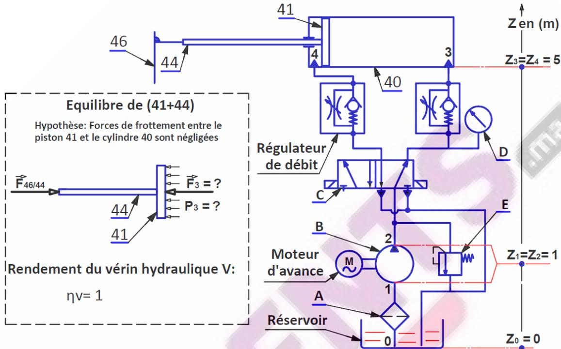
Le schéma partiel de l'installation hydraulique ci-dessus est composé :
