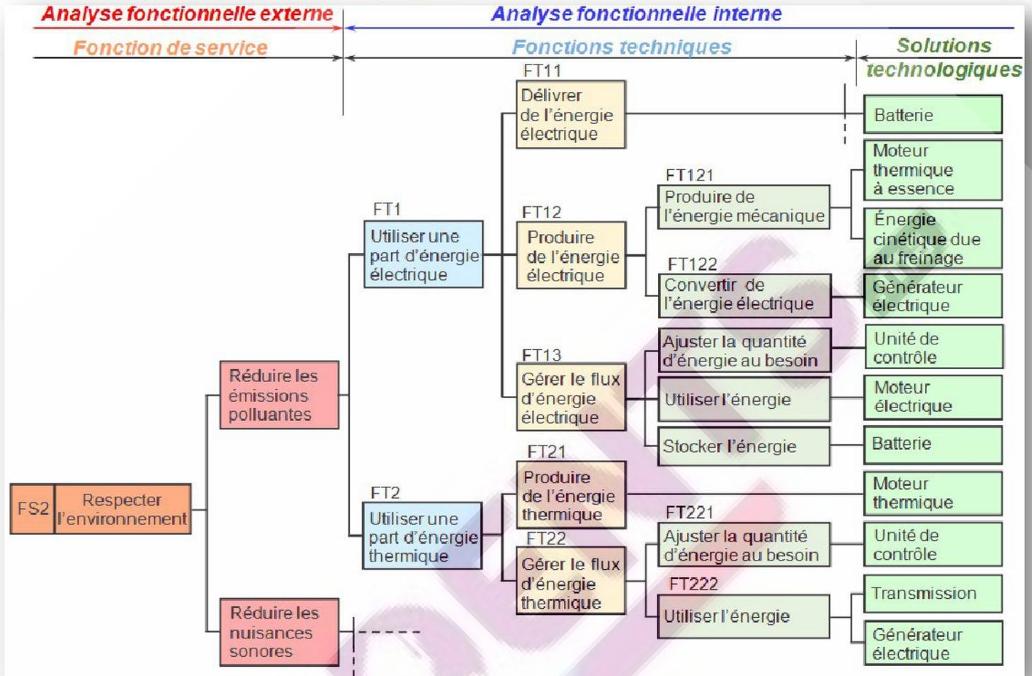
**Exemple :** Le FAST partiel de la fonction de service FS2 de la Segway
