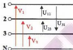
Les tensions  $U_{12}, U_{23}$  et  $U_{31}$  entre phases sont appelés *tensions composées* :  $U_{12} = U_{23} = U_{31} = U$
