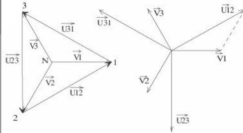
Les tensions  $\vec{V}_1, \vec{V}_2, \vec{V}_3$  entre phase et neutre sont appelés *tensions simples* :  $V_1=V_2=V_3=V$
