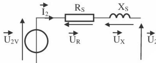
Figure 24 : Schéma équivalent du transformateur vu du secondaire
