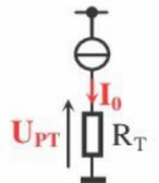
$$\begin{cases} R_T = R_0(1 + \alpha T) \\ \alpha = 3,85 \cdot 10^{-3} \text{ } ^\circ\text{C}^{-1} \\ R_0 = 1000 \Omega \text{ à } T = 0^\circ\text{C} \end{cases}$$
