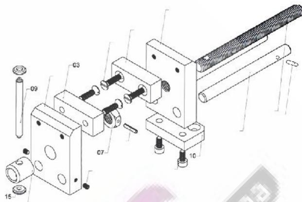
**Le dessin en vue éclatée** représente en perspective les pièces d'un objet les unes par rapport aux autres. Il permet de mieux comprendre le fonctionnement et le montage de l'objet.
