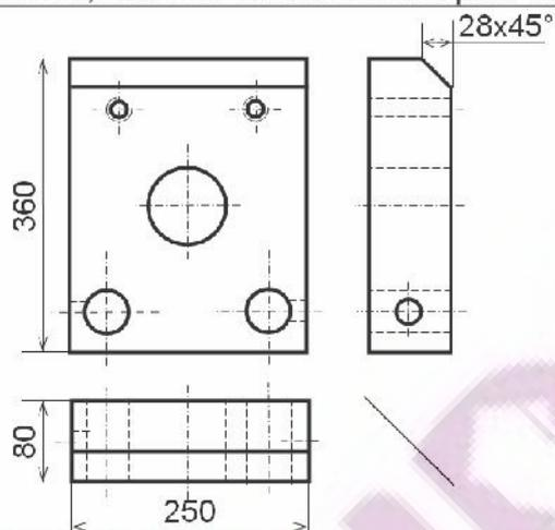
**Le dessin de définition** représente une pièce de l'objet. Il détaille avec précision ses formes et ses dimensions (cotation) en vue de sa fabrication. Il comporte plusieurs vues.
