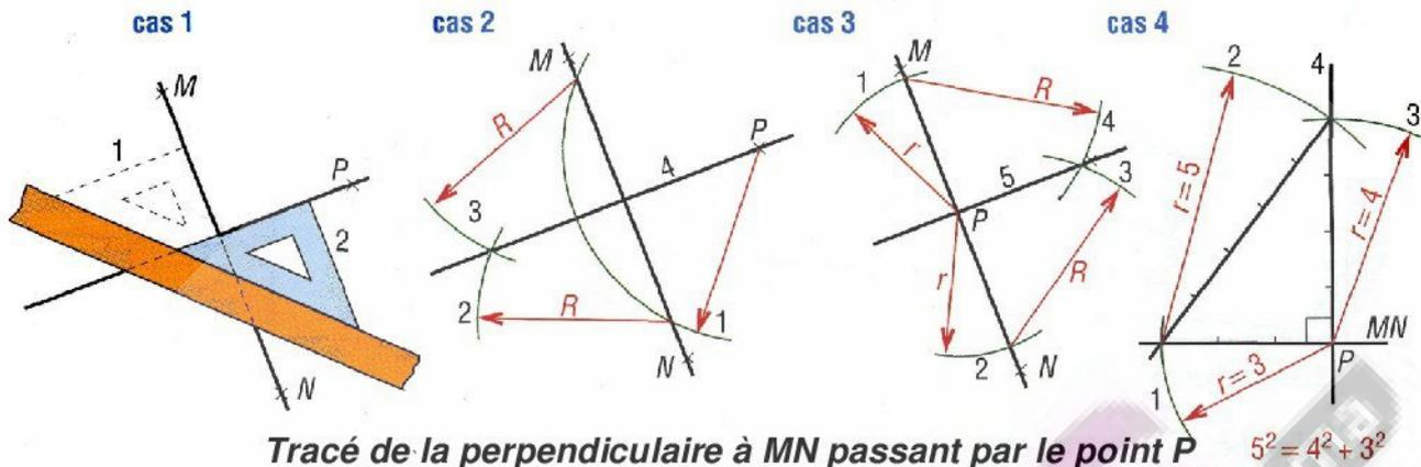
Tracé de la perpendiculaire à MN passant par le point P
