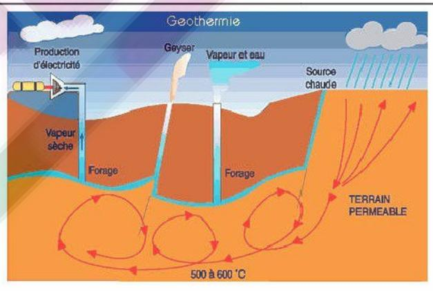
L'énergie géothermique est une énergie due à la chaleur des couches géologiques de la croûte terrestre. L'eau qui circule en profondeur, en s'échauffant, permet le transfert de la chaleur vers la surface. La vapeur de cette eau, récupéré en surface ou reconduit de la profondeur par des forages, est utilisée pour faire tourner des turbines produisant de l'électricité.
