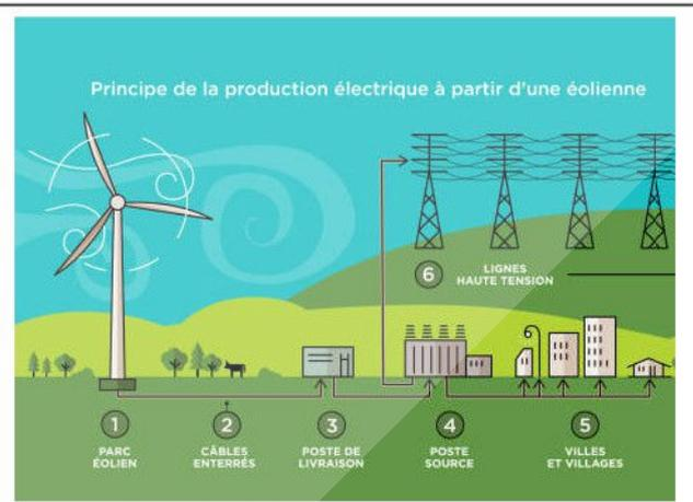
L'énergie éolienne désigne l'énergie cinétique véhiculée par les masses d'air, c'est-à-dire par le vent. Les éoliennes ou aérogénérateurs se chargent ainsi de convertir l'énergie éolienne en une énergie mécanique qui alimente ensuite un générateur électrique, ou elle est convertie en électricité.
