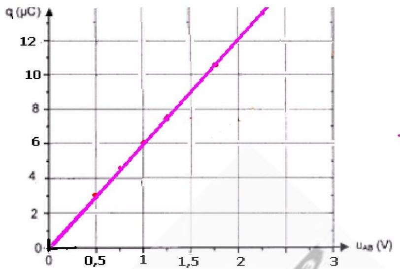
تتناسب شحنة المكثف مع التوتر المطبق بين مربطيه و معامل التناسب بينهما ثابتة تميز المكثف، تسمى : سعة المكثف. ويرمز إليها بـ **C**.
