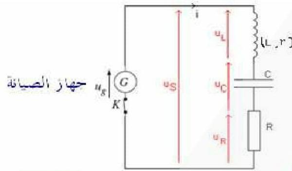
المولد  $G$  يزود الدارة بتوتر يتناسب اطرادا مع شدة التيار الكهربائي الذي يعبر الدارة.  $u_g = R_o.i$  (مع  $R_o = R + r$ ) وهو يتصرف كمقاومة سالبة.
