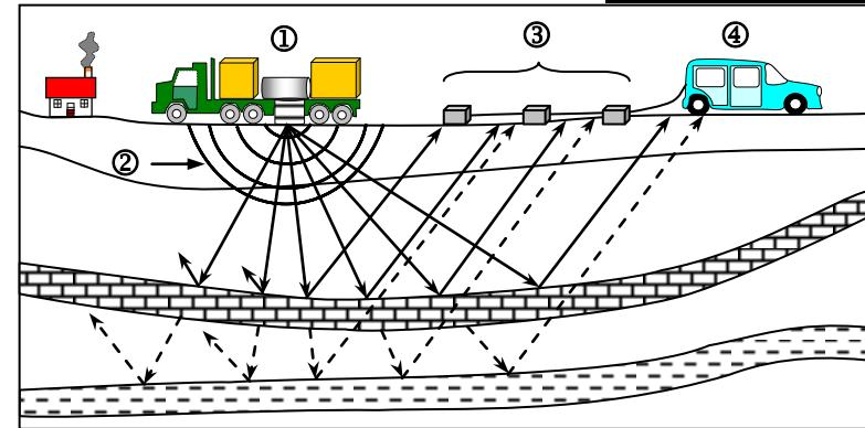
★ طريقة التنقيب الزلزالية: الشكل أمامه انطلاقاً من شاحنة خاصة مرسلة للاهتزازات (①)، ترسل اهتزازات (②) إلى باطن الأرض، وتلتقط بواسطة مسجلات لاهزازات شديدة الحساسية (③)، فترسل هذه المعطيات إلى شاحنة بها حاسوب لمعالجتها (④). تسمح سجلات الاهتزازات المحصل عليها بمعرفة طبيعة الصخور في باطن الأرض وتحديد إمكانية وجود سدائم.
